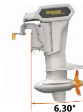
Abb. 30: Motor vollständig heruntergekippt
